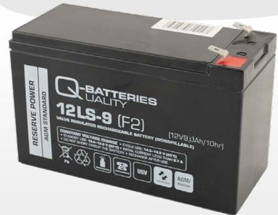
Bei der Q-Batteries LS-Serie handelt es sich um ventilregulierte und wartungsfreie AGM-Akkus (Absorbent Glass Mat-Technologie), die besonders für Stand-by-Anwendungen, wie zum Beispiel in der Sicherheitstechnik, Brandmeldetechnik, USV und UPS, entwickelt wurden.
