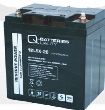
Bei den Q-Batteries-Akkus der LSX-Serie handelt es sich um ventilregulierte und wartungsfreie AGM-Akkus (Blei-Vlies-Technologie), die gebrauchsdaueroptimiert konstruiert wurden. Bei der Legierung handelt es sich um eine spezielle Blei-Calcium-Zinn-Legierung. Das Design-Life beträgt 10 Jahre plus. Während der langen Lebensdauer können die Akkus wartungsfrei betrieben werden. Die Akkus dieser Serie wurden speziell für STANDBY-Betrieb mit erhöhter Anforderung an die Lebensdauer entwickelt.
