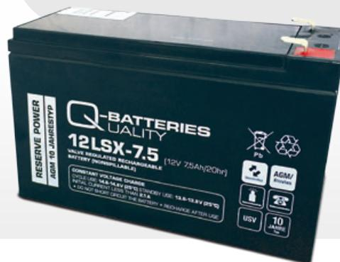
Bei den Q-Batteries-Akkus der LSX-Serie handelt es sich um ventilregulierte und wartungsfreie AGM-Akkus (Blei-Vlies-Technologie), die gebrauchsdaueroptimiert konstruiert wurden. Bei der Legierung handelt es sich um eine spezielle Blei-Calcium-Zinn-Legierung. Das Design-Life beträgt 10 Jahre. Während der langen Lebensdauer können die Akkus wartungsfrei betrieben werden. Die Akkus dieser Serie wurden speziell für STANDBY-Betrieb mit erhöhter Anforderung an die Lebensdauer entwickelt.
