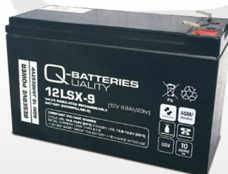
Bei den Q-Batteries-Akkus der LSX-Serie handelt es sich um ventilregulierte und wartungsfreie AGM-Akkus (Blei-Vlies-Technologie), die gebrauchsdaueroptimiert konstruiert wurden. Bei der Legierung handelt es sich um eine spezielle Blei-Calcium-Zinn-Legierung. Das Design-Life beträgt 10 Jahre plus. Während der langen Lebensdauer können die Akkus wartungsfrei betrieben werden. Die Akkus dieser Serie wurden speziell für STANDBY-Betrieb mit erhöhter Anforderung an die Lebensdauer entwickelt.
